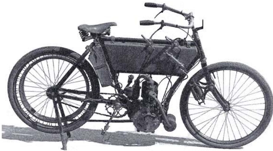
Motor monocilíndrico de 430.5 cc distribuci3n ioe. 4.5 CV (1903)
